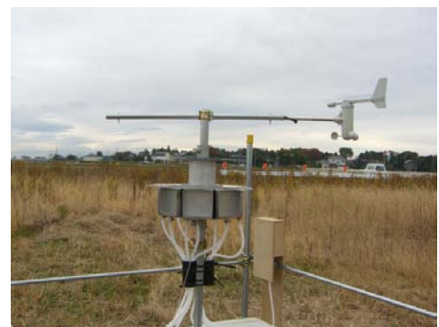
写真-1 飛来塩分捕集器具の設置状況
