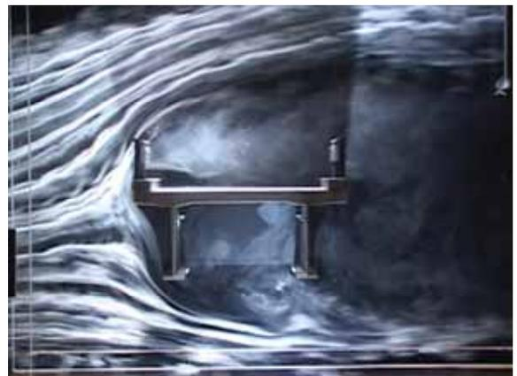
写真1 流れの可視化実験結果
