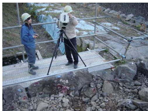
写真-2 形状測定装置による測定状況
