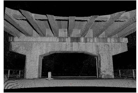
図-3.1 橋梁の形状計測例
