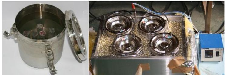
図2 岩石供試体の温度管理(90℃)
