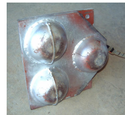
写真-3 起振機裏面詳細
