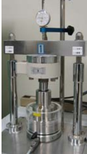
図2 高压圧密試験装置 (左：全体写真, 右：拡大写真) 図3 高压圧密試験装置の概略図
