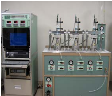
図2 高压圧密試験装置 (左：全体写真, 右：拡大写真) 図3 高压圧密試験装置の概略図
