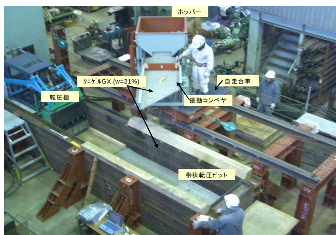
図3 今回の転圧施工試験装置とその状況
