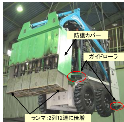
図1 ランマ転圧機の改造箇所
