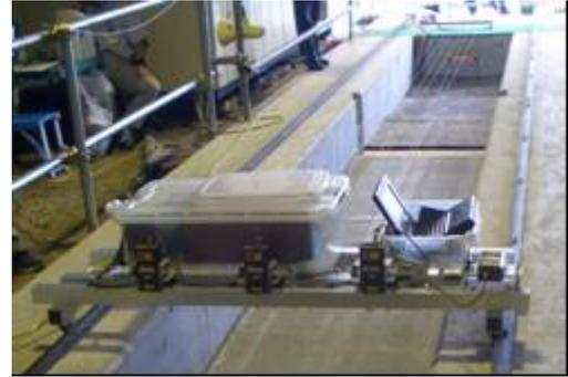
写真-3 レーザー距離センサ
