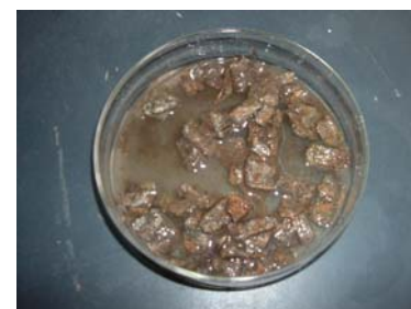
写真—3 木片コンクリートの水浸 (試料2006年10月採取)
