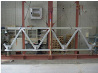
図-5 荷重試験状況
