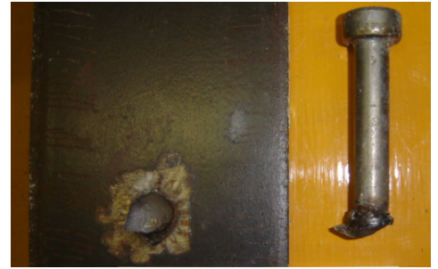
図2 スタッド破断状況 (FTA)
