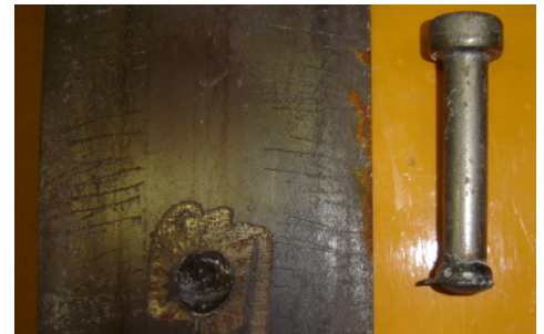
図3 スタッド破断状況 (FTC)
