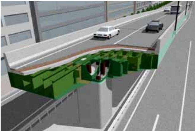
図-1 開断面箱桁複合ラーメン橋の概念図
