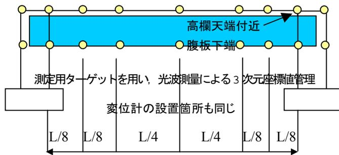
図-5 光波による測量用ターゲット設置箇所
