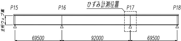
図 1 ひずみ設置位置（中間支点上）
