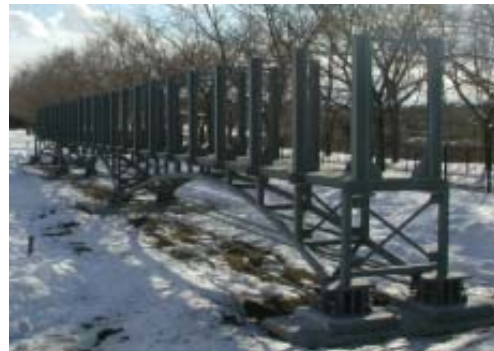
図1 Bow String Arch 実験橋
