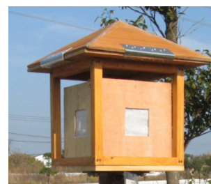
図5 観測設備内に設置されたガーゼプレート
