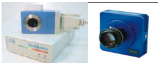
図1 液晶チューナブルフィルターとCCDカメラ
