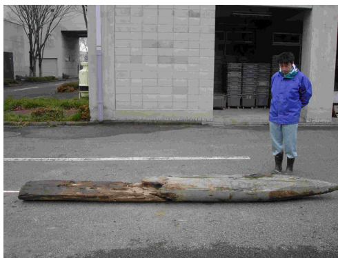
写真-2 木杭の全容
