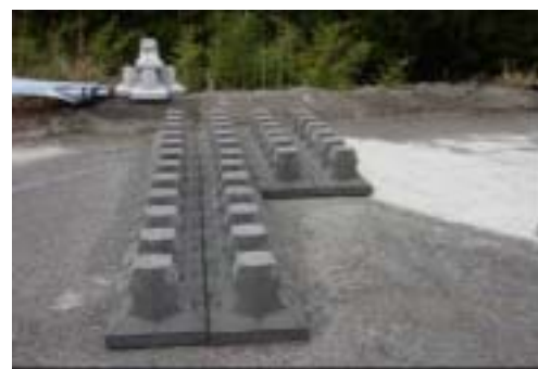
写真3 S焼却灰で製造した積みブロック
