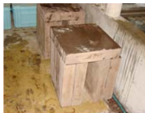
写真4 K焼却灰で作製した平版
