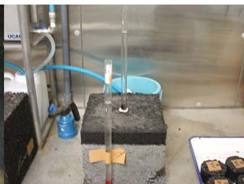
写真-2 境界面の通水試験状況
