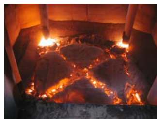
図-5 無害化処理の状況(左より農薬の詰め込み、溶融状況、固体の取り出し)
