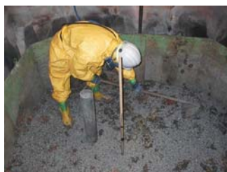
図-5 無害化処理の状況(左より農薬の詰め込み、溶融状況、固体の取り出し)
