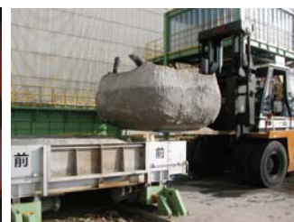
図-5 無害化処理の状況(左より農薬の詰め込み、溶融状況、固体の取り出し)
