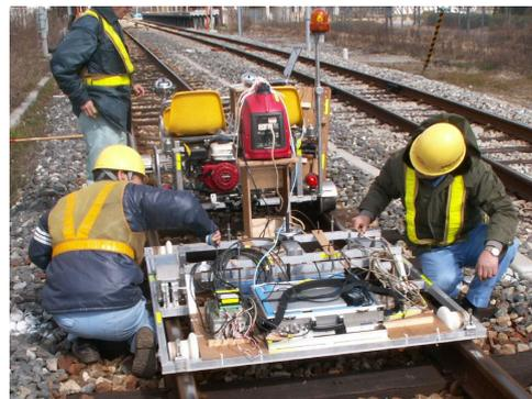
写真-1 レーダ探査用走行台車
