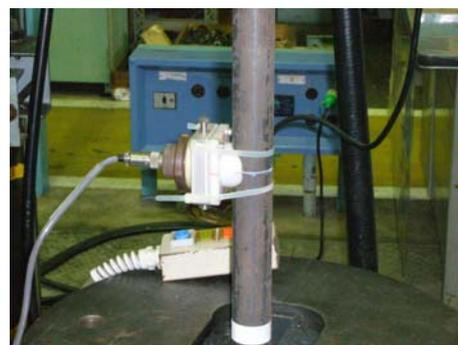
写真-1 応力測定状況
