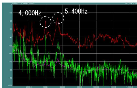
図-5 FFT解析(欠陥部)
