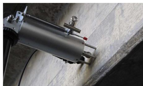
図-7 作業状況(打検機本体)
