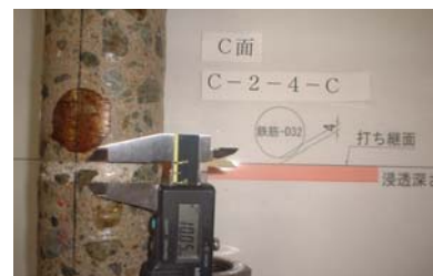
写真-1 絶縁材浸透深さ測定状況
