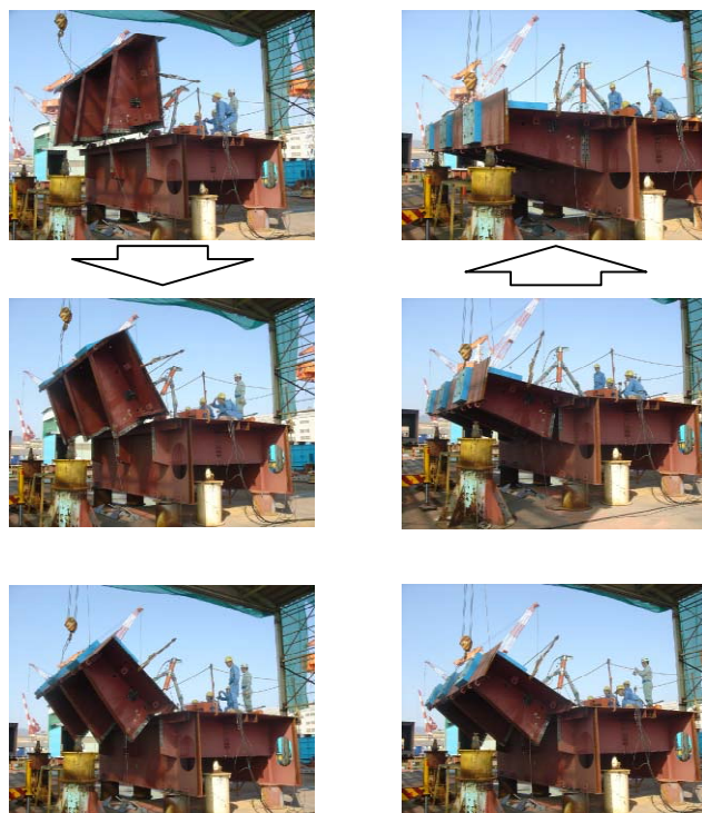
図-4 展開装置によるブラケット展開動作
