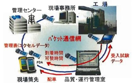
図-4 運行・打設システム概要
