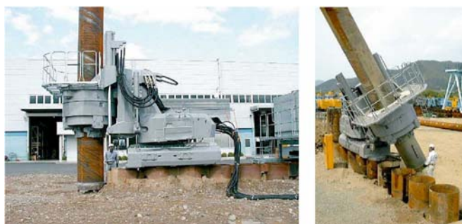
写真-2.ジャイロパイラー
