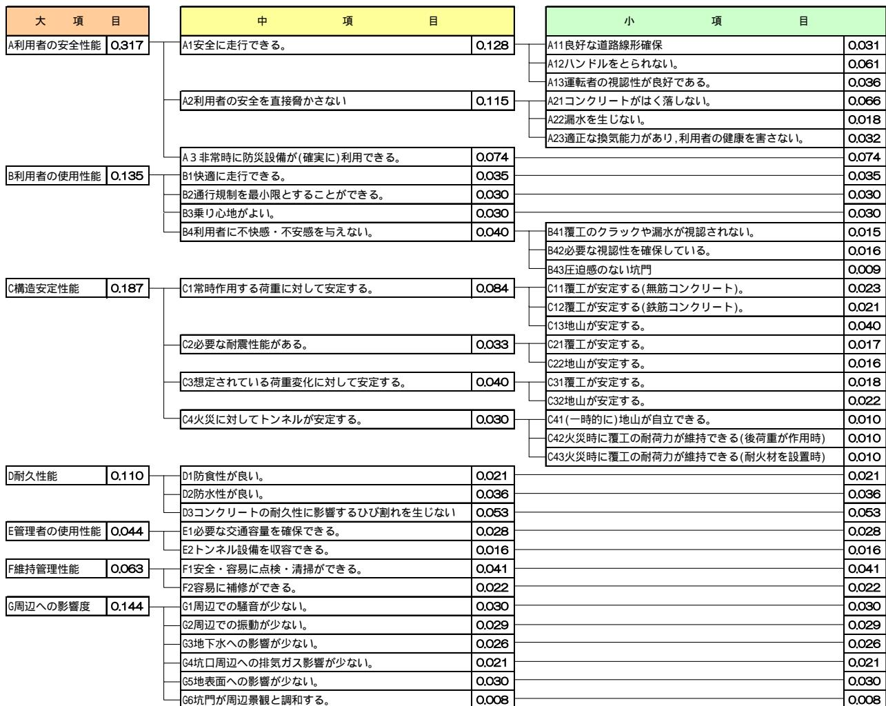
図-3. AHPにより設定した重み係数(山岳道路トンネルの場合)
