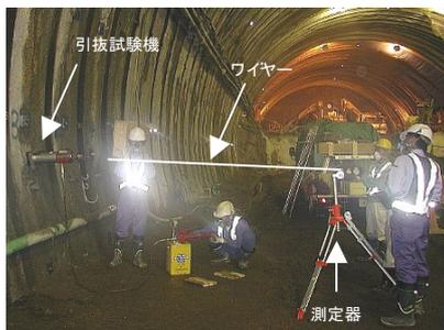
図4 ロッド先端変位測定状況
