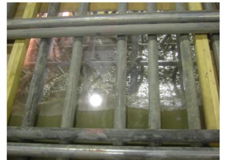
写真-1 前面アクリル板による充填確認
