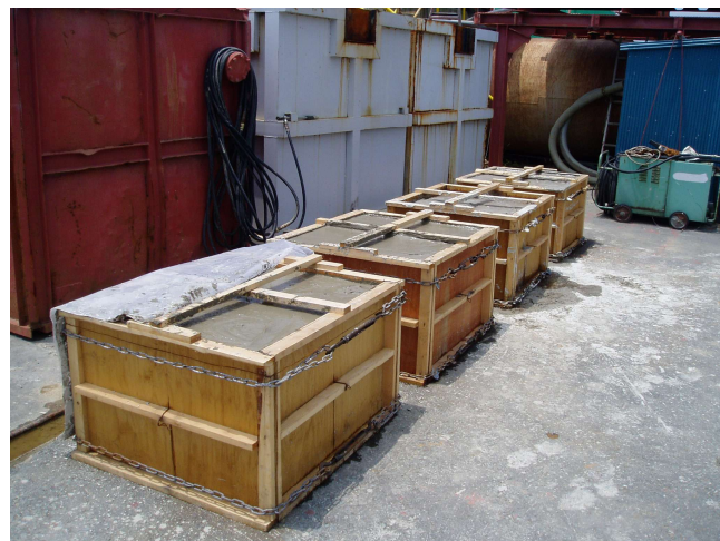
写真-1 打設された流動化処理土
