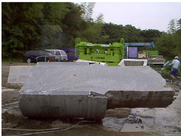
写真-2 試験体切断部状況
