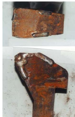
写真-1 ビット磨耗状況
