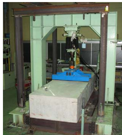
写真-2 繰返し載荷試験状況
