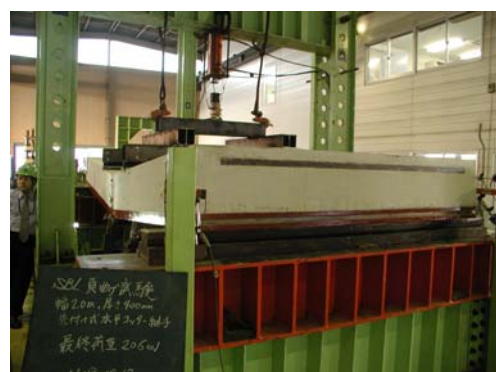
図-7 負曲げ荷重状況
