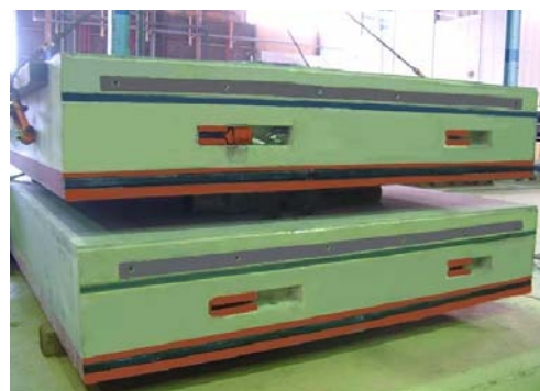
図-1 SBL セグメント継手
