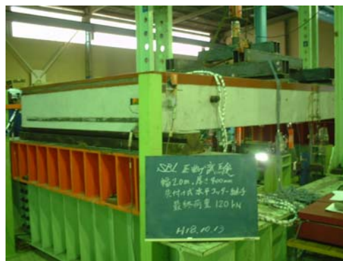
図-5 正曲げ荷重状況
