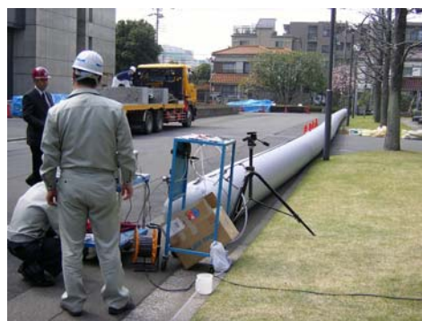
写真-2 φ0.6m風管の屋外実験状況
