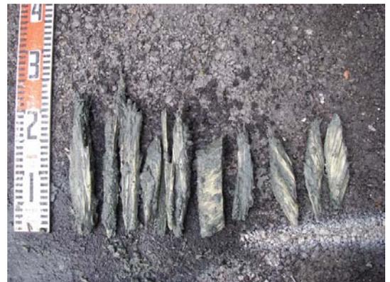
写真-3 FFU横矢板切削くず
