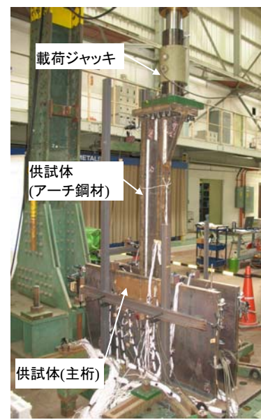
写真-3 定着部载荷試験状況
