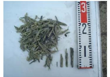
写真-2 FFU 切削くず
