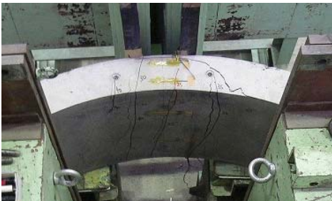
写真-1 ケース 4 試験状況（破壊荷重時）
