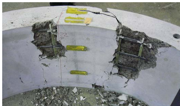
写真-2 破壊状況（ケース2） 《補強筋の内面へのはらみに伴うコンクリート剥離》
