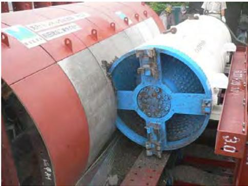
写真-4 セグメント切削試験状況 (ケース1)
