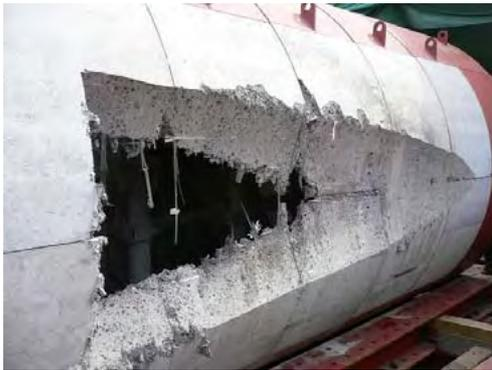
写真-5 切削試験完了状況 (ケース2)
