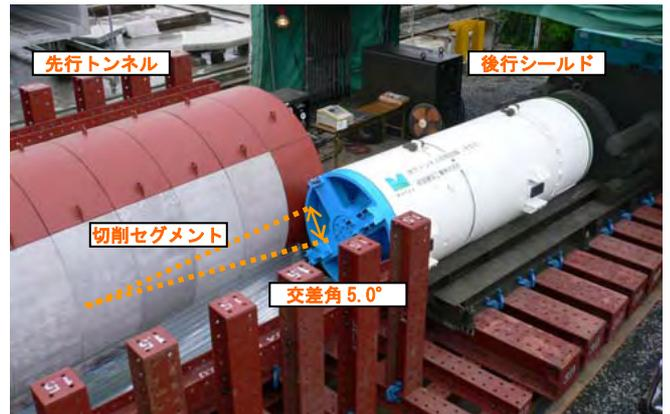
写真-1 切削試験全景
