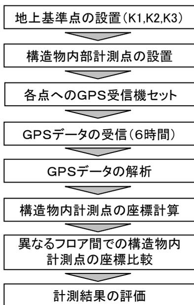
図-2 鉛直施工性計測の流れ
