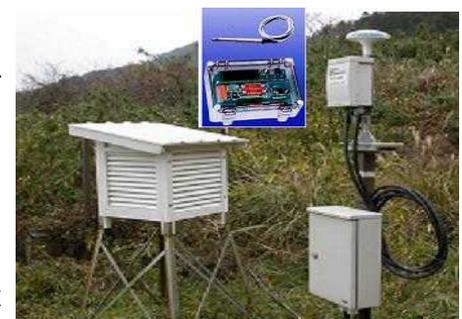
図-4 計測現場に設置した温湿度計
