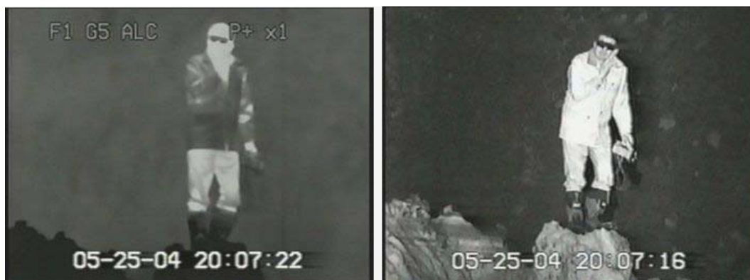
図-1 赤外線画像(左)とレーザーカメラ画像(右)比較
