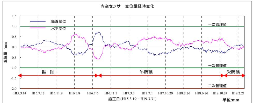
図3 内空変位の経時変化(内空センサ)
