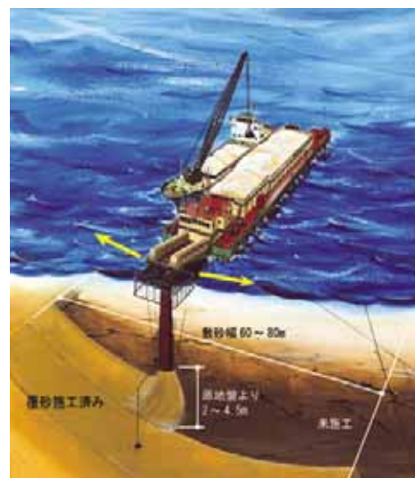
図-1 コンベヤーバージ工法概念図
