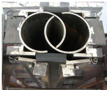
写真-2 漏洩防止ゴムの耐圧性能および変形量の確認実験模型
