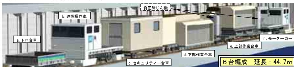
図-2 石綿作業台車(換気口部用)
